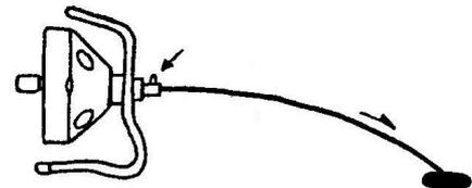
2. Kurbeln Sie mit dem Griff am Magazin im Uhrzeigersinn und schieben Sie das Gerät mit leichtem Druck nach vorne bis sich die Verstopfung löst. Bilden Sie alternativ mit der Spirale einen Spannungsbogen, d.h., dass die Spirale vor der Maschine einen Bogen bildet. Üben Sie nun mit der Hand während des Kurbelns Druck auf den Bogen aus, so dass sich der Druck über die Spirale auf die Verstopfung überträgt.
